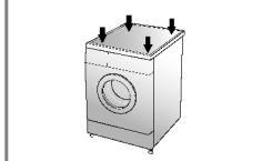
1. Для предотвращения вибрации и чрезмерного шума необходимо придать стиральной машине строго горизонтальное положение. Стиральную машину следует устанавливать на твердом, ровном полу, желательно в углу комнаты.
